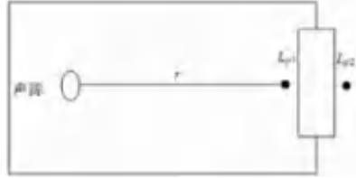
图6.4-1 室内声源等效为室外声源图例
